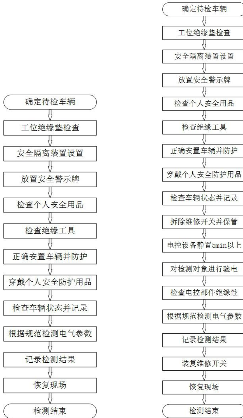
图 1 高压在线检测流程和断电检测流程
