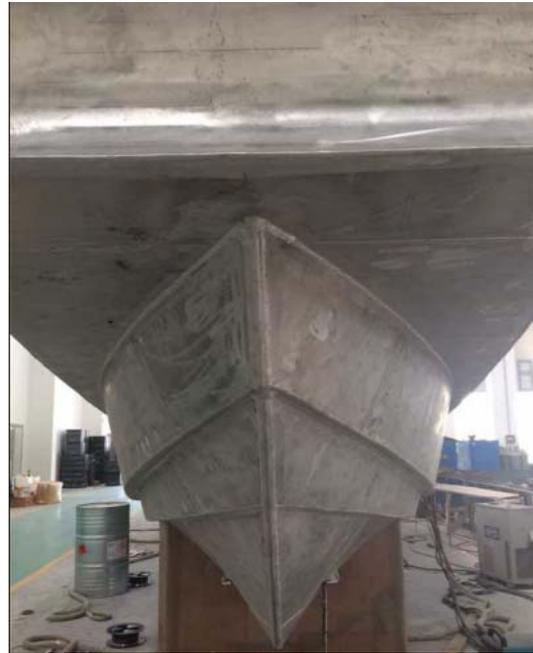
图2 铝合金高速艇船体船底结构
